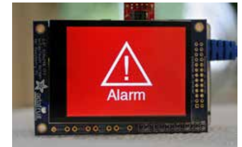
Mit dem Display können beliebige Geräte gesteuert oder Informationen angezeigt werden. Aktuelle Beispiele sind die Stereoanlage (grün), das Raumklima (blau), ein Navigationsmenü (gelb) und ein Alarm.
